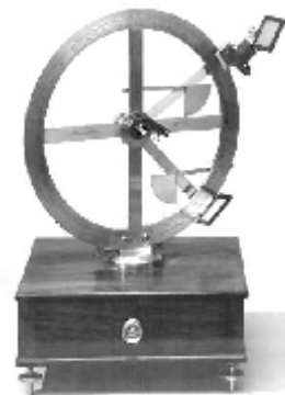
अपवर्तनांक ज्ञात करने के लिए एक उपकरण। कोणों को सही-सही नापने के लिए इसमें वर्नियर पैमाने की व्यवस्था की गई है।
